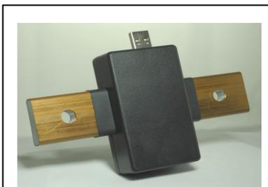
*Beispiel eines SCSS montiert auf einer Sammelschiene von 300 mm<sup>2</sup> Querschnitt für eine Dauerbelastung +/- 600 A mit einer USB Datenschnittstelle.*
